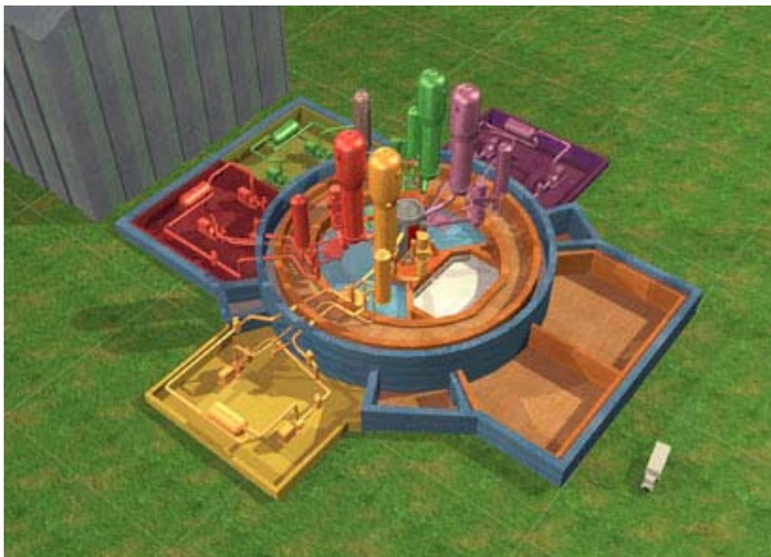
Figura E.1 – Sistemi di ‘treni’ indipendenti del reattore EPR [8]
